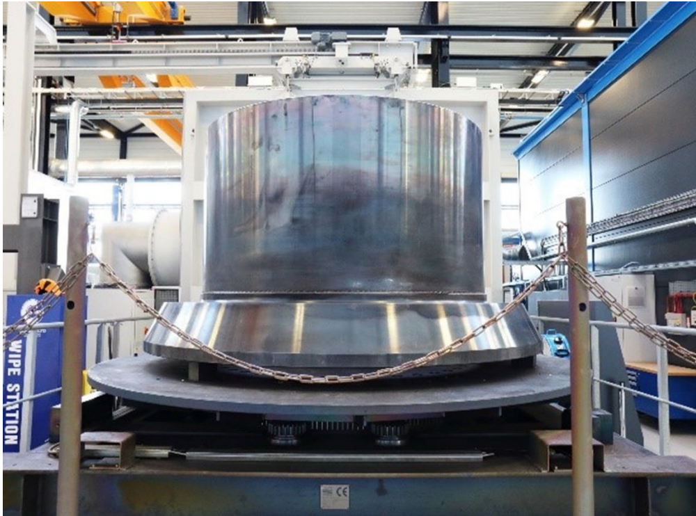
[Peiriant Weldio Paladr Electronau yn ffatri ymchwil yr AMRC Niwclear yn Ne Swydd Efrog]
