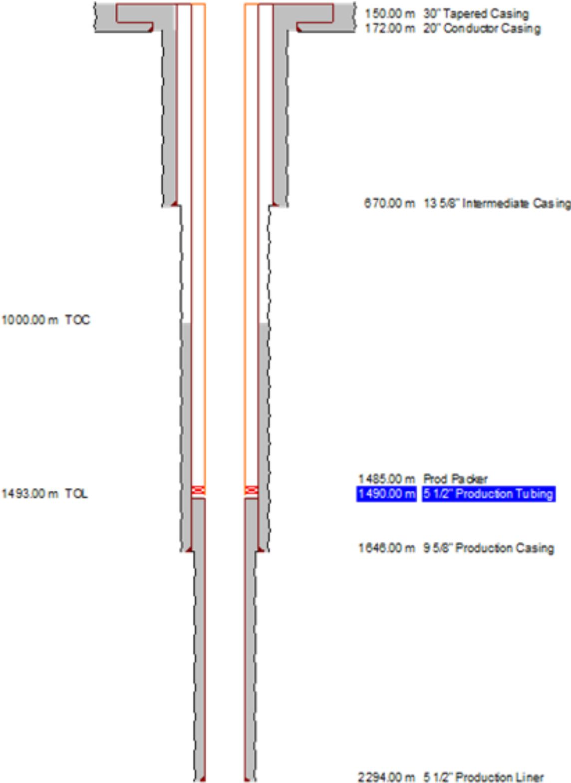
Figure 43 CO2 Injector Schematic (d)
