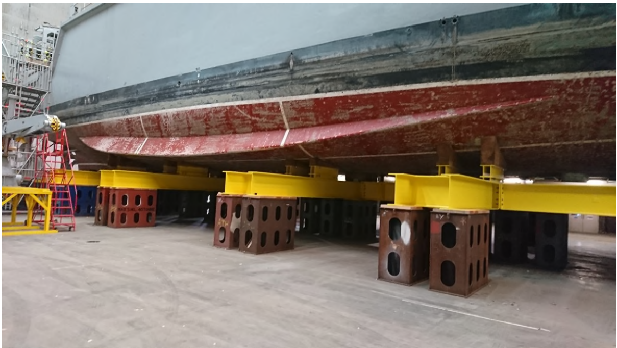
Starboard bilge keel view.
