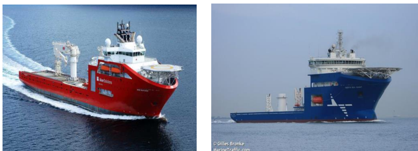
Figura 34: Embarcaciones con posicionamiento dinámico desplegadas en el sitio de pruebas de EMEC para instalar turbinas mareomotrices y estructuras de soporte
