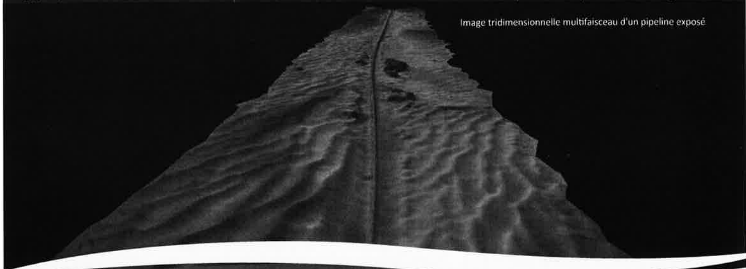
Image prise par sonar à balayage latéral d'un pipeline
