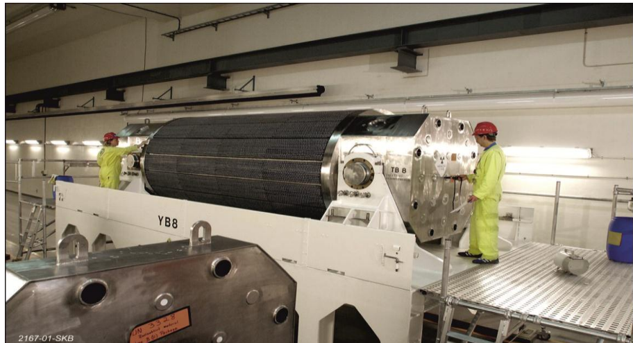
Derbyn casgen gludo Ymbelydredd Lefel Uchel (HLW) yn CLAB (cyfleuster storio gweddillion tanwydd niwclear dros dro dan ddaear) Sweden (trwy garedigrwydd SKB)
