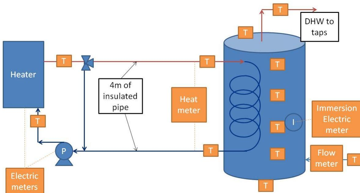
Figure 10: DHW cylinder rig
