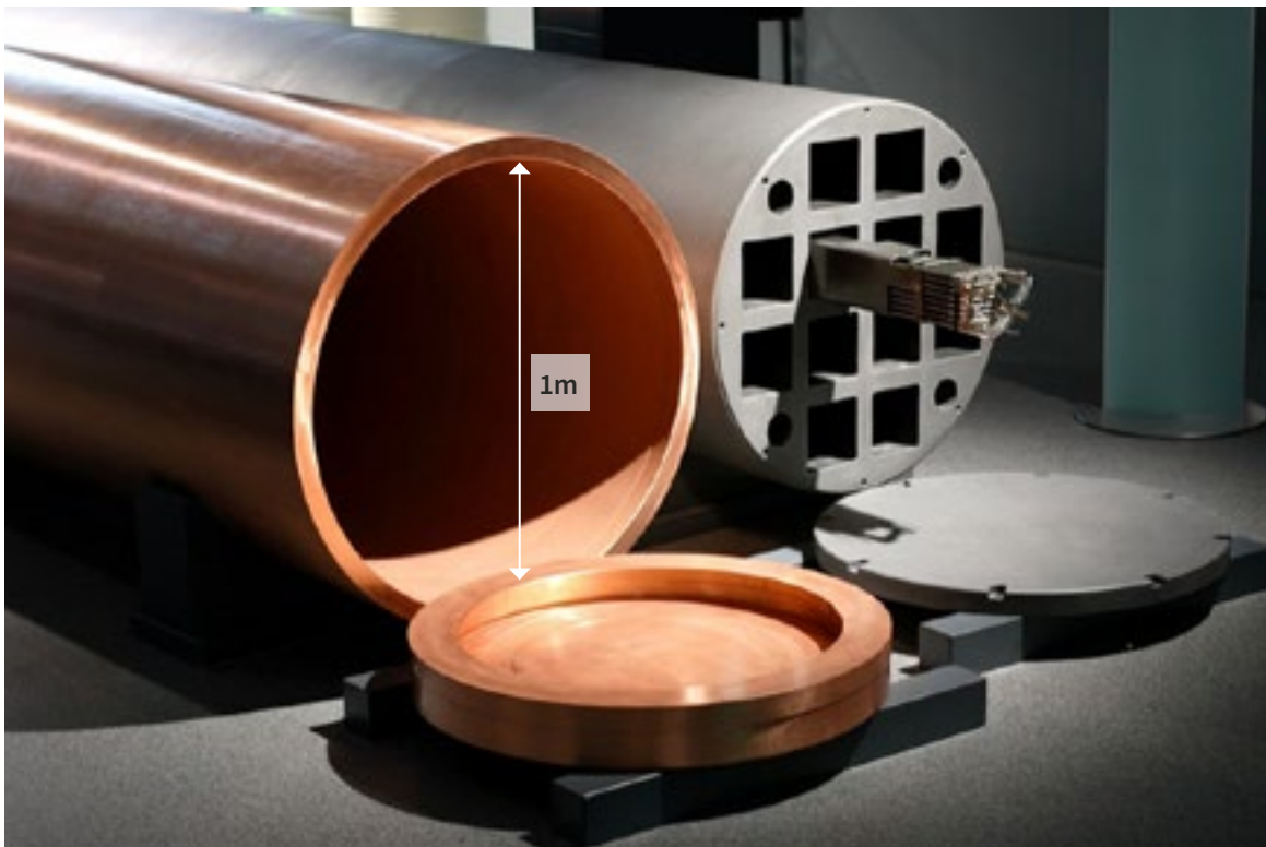
Ffigwr 3: Enghraifft o gynhwysydd gwaredu ar gyfer gweddillion tanwydd fydd yn cael ei ddefnyddio yn y Ffindir. Mae'r cynhwysydd yma wedi ei wneud o gopr, gyda mewnosodiad haearn bwrw (a ddangosir ar y dde) er mwyn ychwanegu cryfder.
