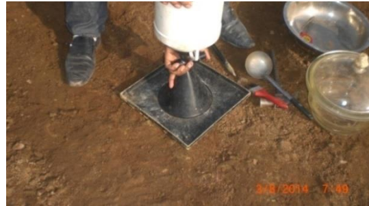
b. Pour the sand to the hole
