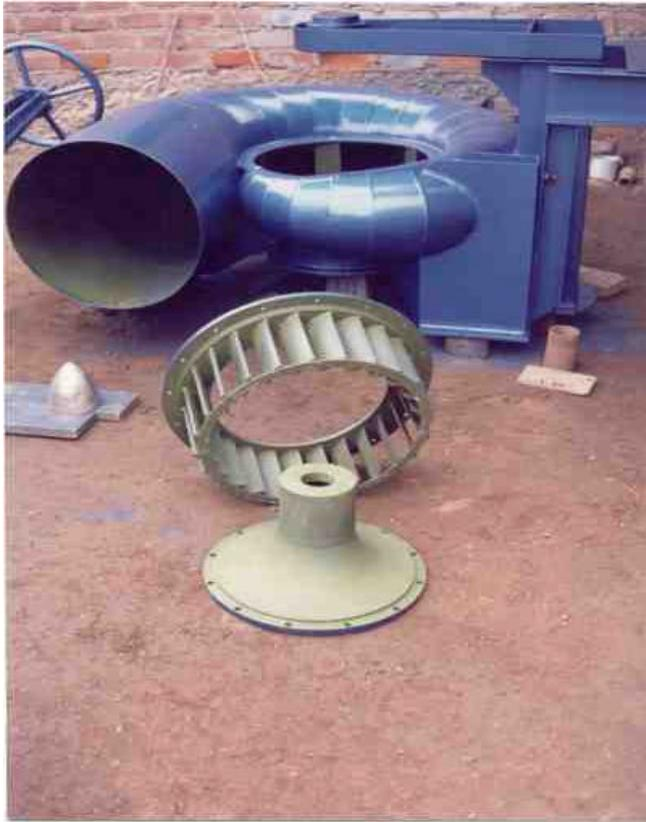
Figura 2: Carcasa de turbina y alabes directrices
