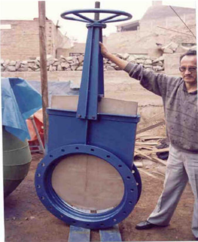
Figura 4: Válvula tipo compuerta
