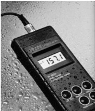
**Figura 36: Condutímetro portátil**
