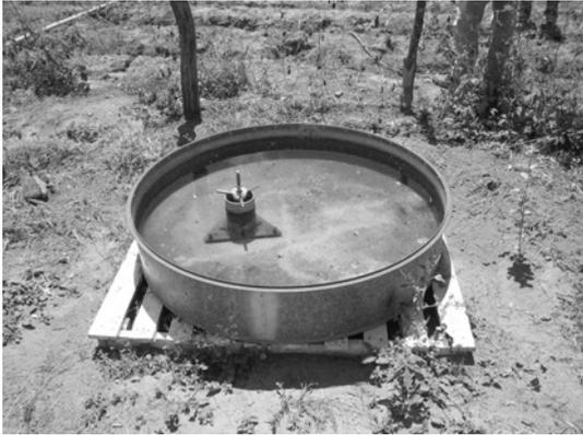
**Figura 33: Tanque classe A**
