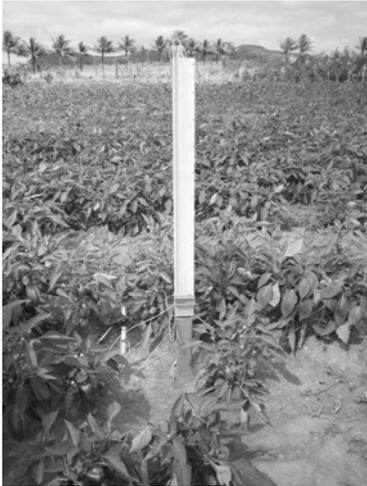
**Figura 35: Tensiômetro**
