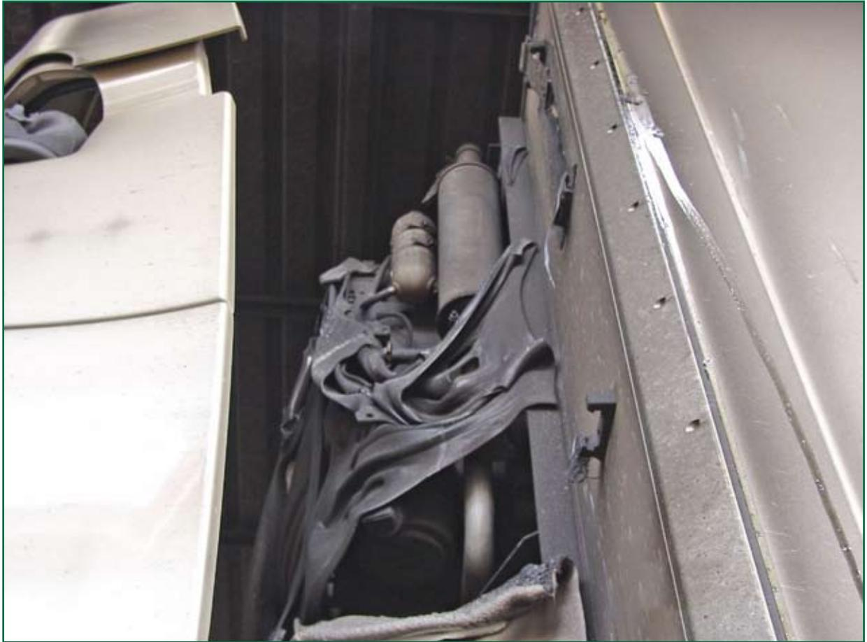
*Figure 5 : Dommages au groupe frigorifique du poids lourd placé derrière le wagon sinistré*
