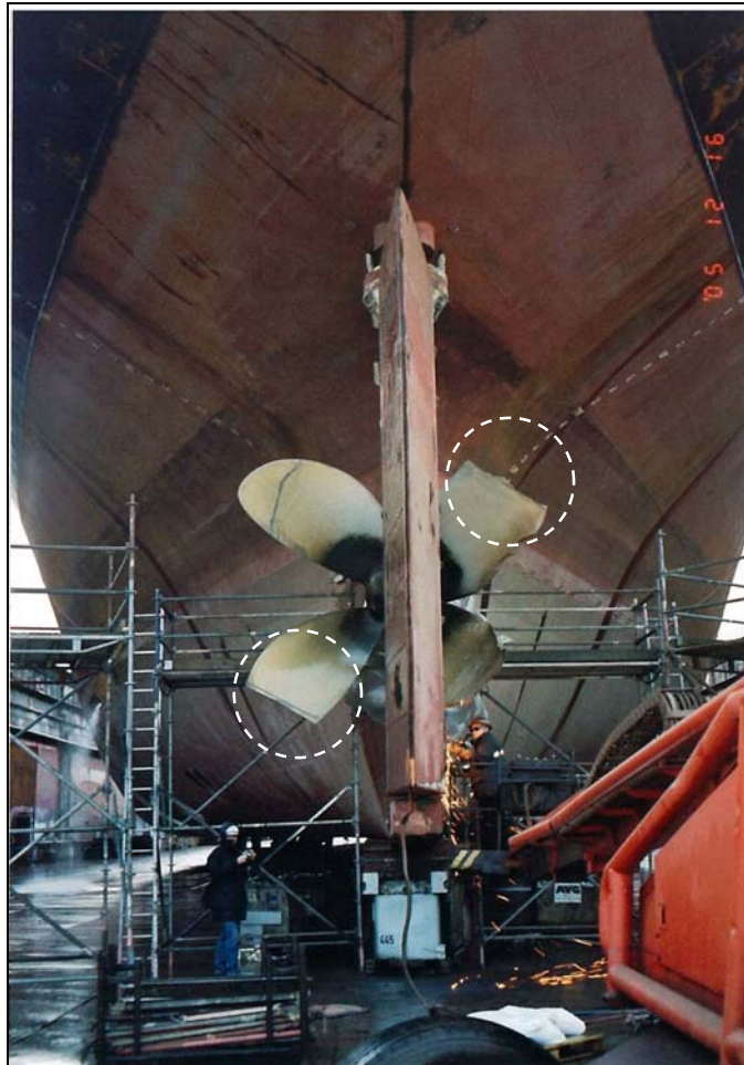
Abbildung 13: Beschädigung des Ruderblattes der Sunny Blossom
