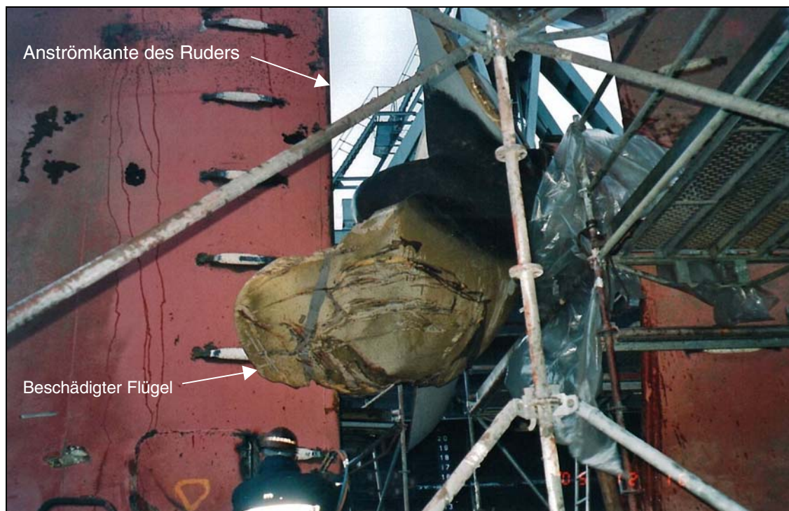
Abbildung 12: Beschädigung des Ruderblattes der Sunny Blossom
