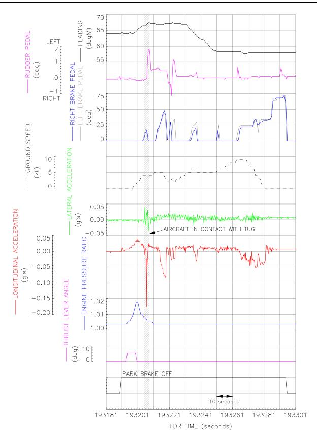
**Figure 3** Salient FDR Parameters
