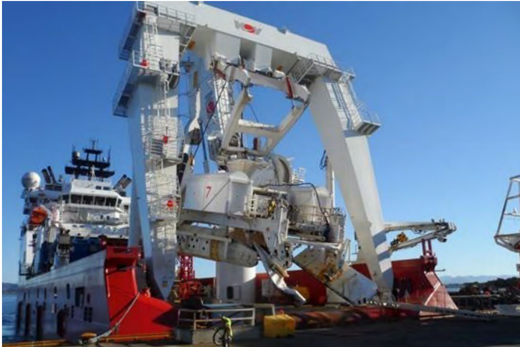
Figure 3-11 Backfill plough (Subsea7)
