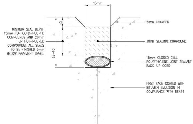
SEALED CONSTRUCTION JOINT
