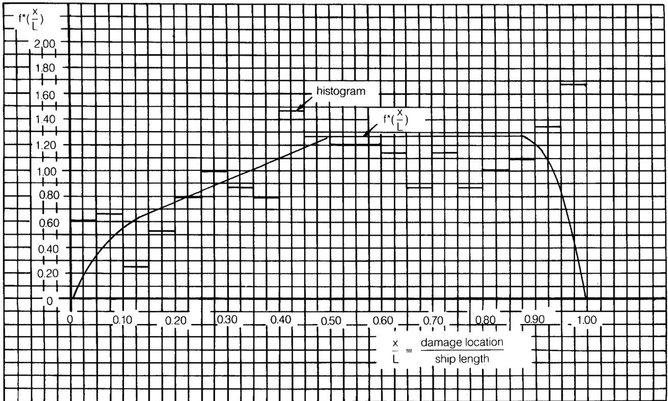
FIGURE 19 - DISTRIBUTION OF NON-DIMENSIONAL DAMAGE LOCATION
