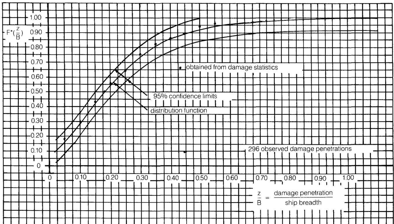
FIGURE 14 - DISTRIBUTION FUCTION OF NON-DIMENSIONAL DAMAGE PENETRATION
