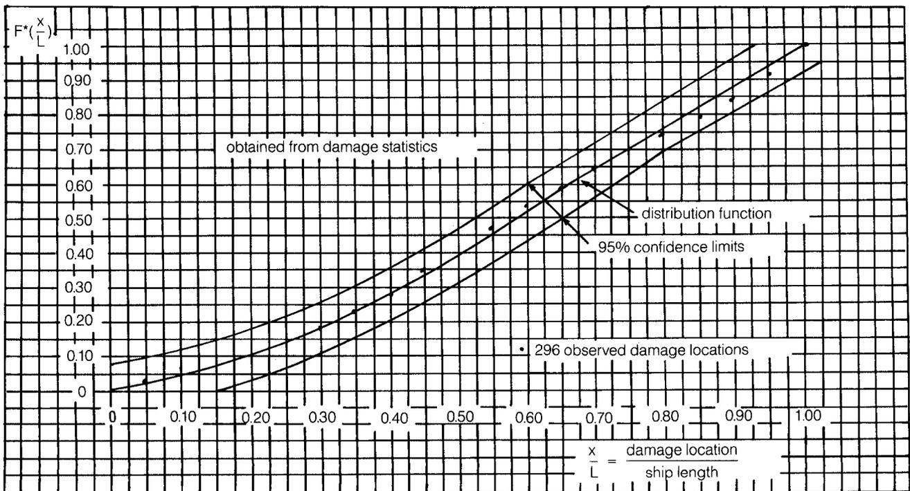
FIGURE 20 - DISTRIBUTION FUNCTION OF NON-DIMENSIONAL DAMAGE LOCATION
