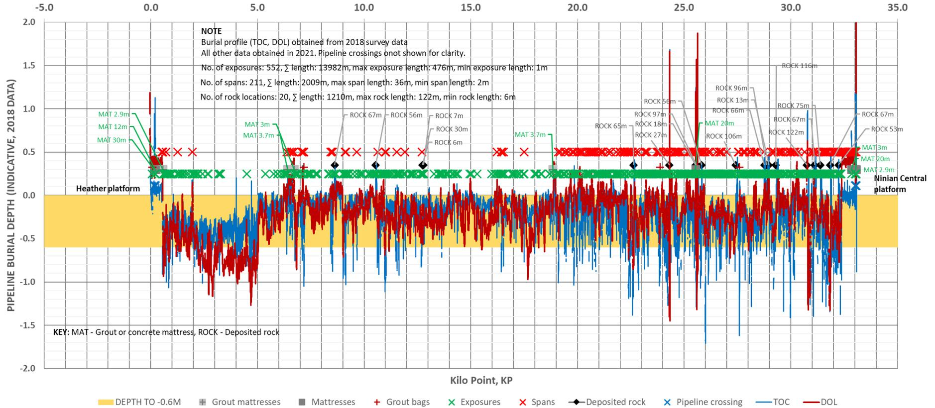
Figure 4.2.7: PL9 pipeline exposures, spans, mattresses, rock, etc. (2021)<sup>5</sup>
