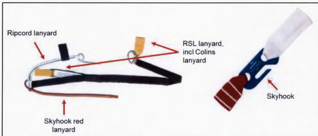
Figure 1.3.A.30<sup>58</sup> – Skyhook RSL components.<sup>59</sup>
