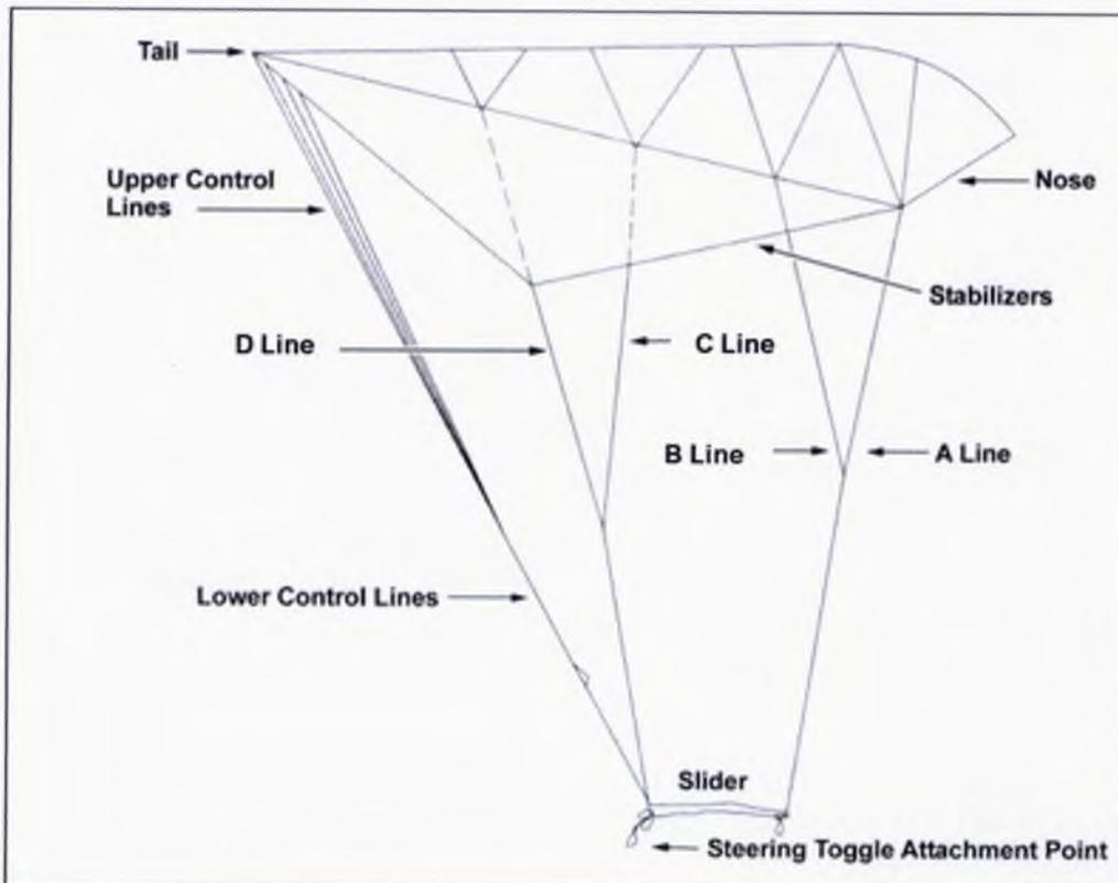
Figure 1.3.A.28 – Rigging lines.<sup>55</sup>
