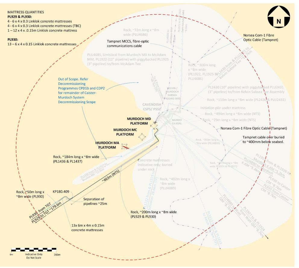
Figure 2.5.1: Murdoch installation 500m zone<sup>5</sup>
